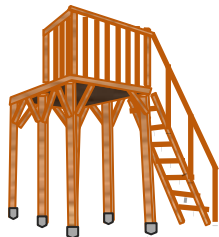
Schemat konstrukcji z drabiną z boku drzwi domku, podwójne krzyżaki wzmacniające
